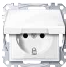
Контактен излаз шуко с капаче с панти, степен на защита IP44 16 A, 250 V AC, DIN 49440
