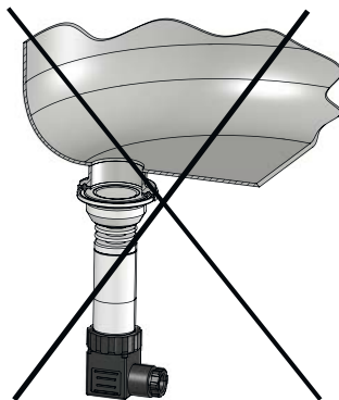
Nicht selbstentleerende Einbausituation
