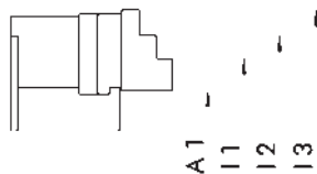
Harte Stufenaufsatzbacken Stahl 16MnCr5, gehärtet Hard Stepped Top Jaws Steel 16MnCr5, hardened
